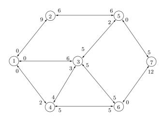
$$\begin{array}{rrrr} 1 \rightarrow 2 \rightarrow 5 \rightarrow 7 & : & \mbox{flow 5} \\ 1 \rightarrow 3 \rightarrow 6 \rightarrow 7 & : & \mbox{flow 5} \\ 1 \rightarrow 4 \rightarrow 6 \rightarrow 7 & : & \mbox{flow 2} \\ 1 \rightarrow 3 \rightarrow 4 \rightarrow 6 \rightarrow 7 & : & \mbox{flow 1} \end{array}$$
