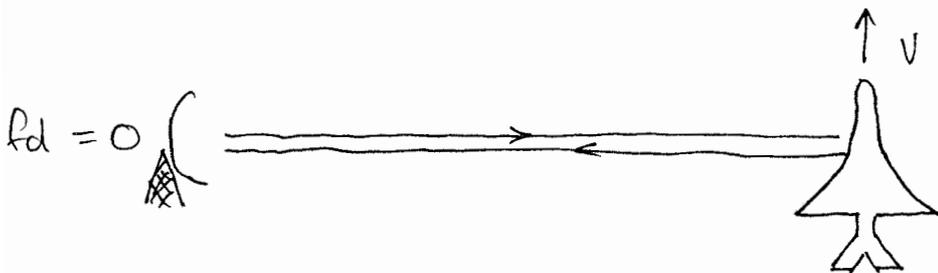
THE VELOCITY  $V_r = V \cos \theta$  WHERE  $\theta$  IS THE ANGLE BETWEEN THE RADAR ANTENNA AND THE TARGET'S TRAJECTORY
